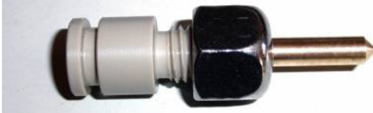
Hot-End Düsenhaltemutter montiert
